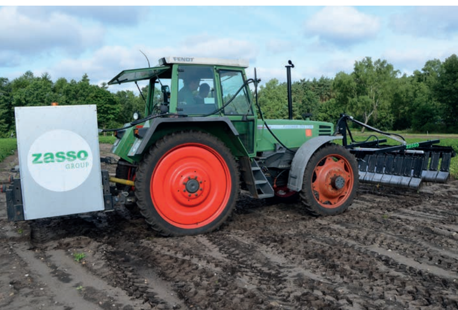
Unten: Einsatz von elektrischem Strom zur Krautminderung von Kartoffeln. Foto: Versuchsstation Dethlingen
