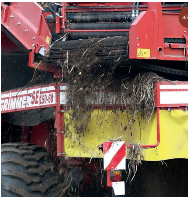
Abb. 5: Über zu hoch eingestellte Ableitwalzen gelangen vor allem kleine Knollen zurück auf das Feld
